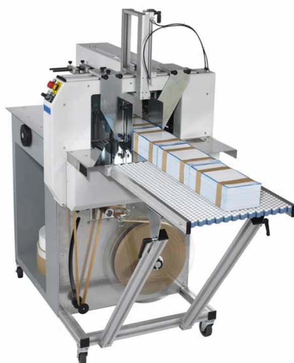
Auslage mit doppelt gebündelten Paketen (in zwei Arbeitsschritten). Die zuschaltbare Doppelbündelung ist im Standard-Lieferumfang enthalten.
