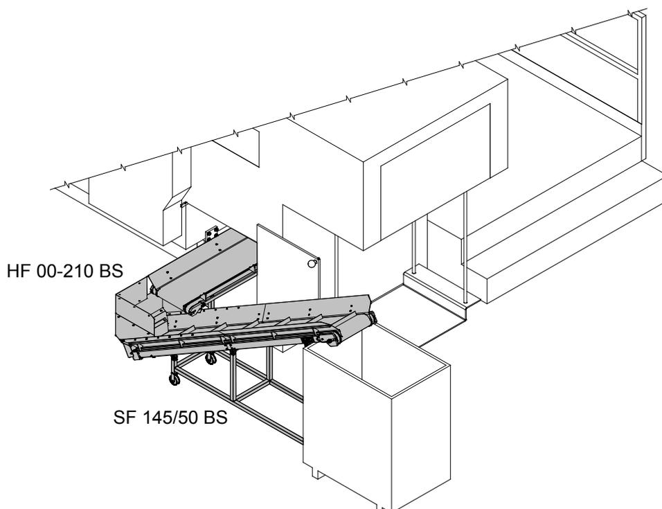
mit zwei Späneförderbändern in Spänecontainer bis 190 cm Höhe
