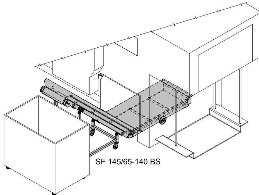
mit einem einzelnen Späneförderband in einen Spänecontainer bis 145 cm Höhe
