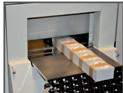
3. Automatisches Pressen und Bündeln der Produktstapel
